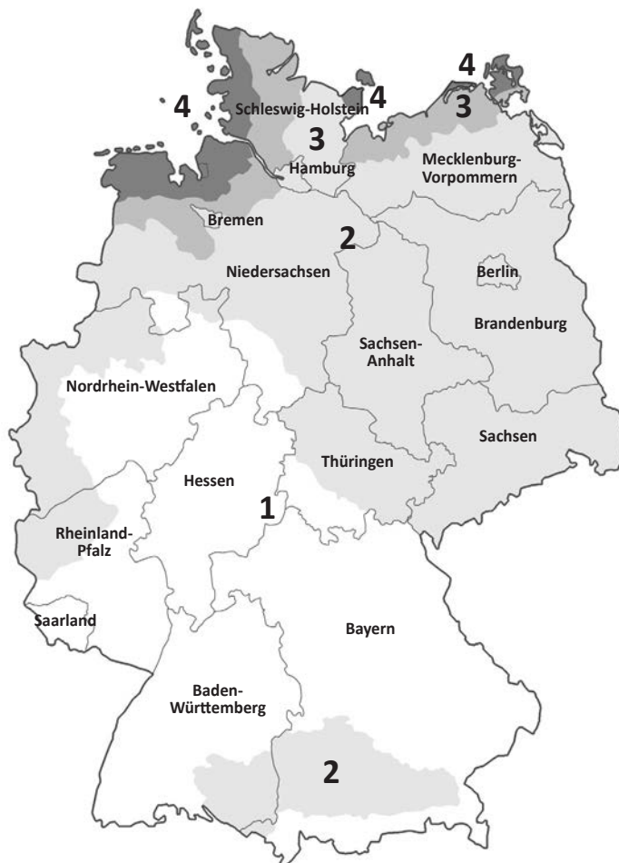
Zuordnung der Windwiderstandsklassen zu den Windlastzonen in Deutschland
