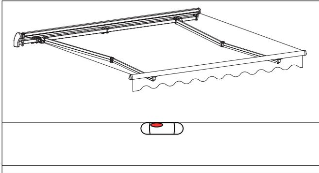
Lösen Sie VORSICHTIG und max. 2 Umdrehungen die Schrauben „A“ an den Gelenkarmen mit einem 3 mm Inbusschlüssel.
