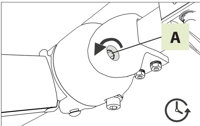
Schraube im Uhrzeigersinn drehen - Ausfallprofil „heben“
