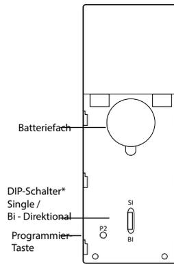
**HSR-Handsender Rückseite bei geöffnetem Deckel**
