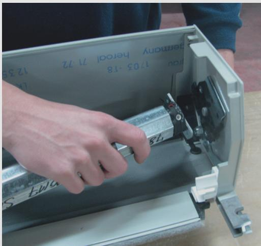
10.1 Das Einrasten der Motorkopfplatte im Klicklager muss deutlich spürbar (hörbar) sein.
