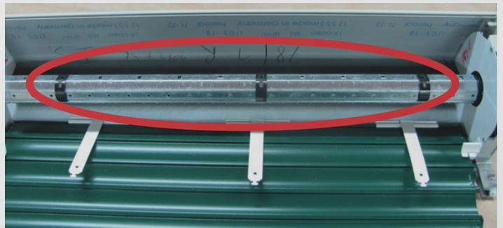
3. Schrauben beider Abweisbleche lösen und entfernen.
