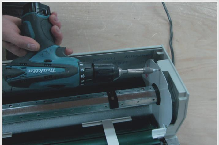
13. Alle Sicherungsfedern wieder an den Einhängeklammern befestigen.
