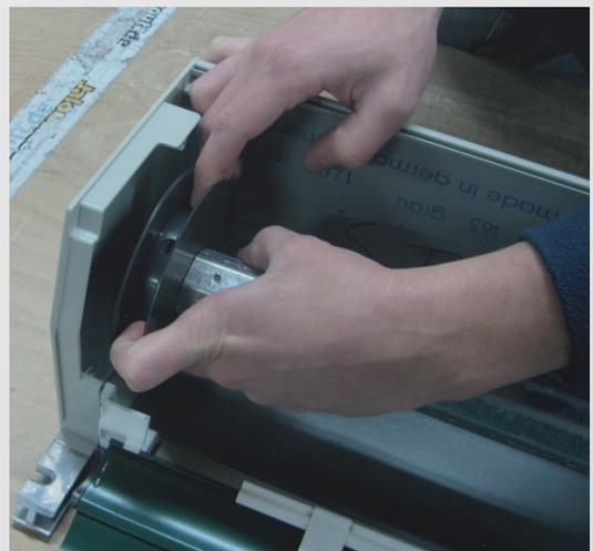
6. Den Motorkopf (die Rolladenwelle / Antriebsseite), durch Druck auf die seitlichen Lasche/n des Klicklagers vom Lager lösen.
