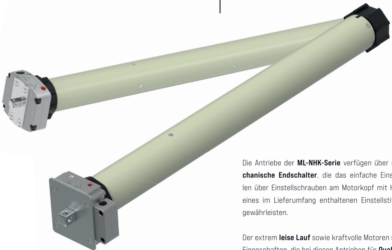
Die Antriebe der **ML-NHK-Serie** verfügen über **mechanische Endschalter**, die das einfache Einstellen über Einstellschrauben am Motorkopf mit Hilfe eines im Lieferumfang enthaltenen Einstellstiftes gewährleisten.
