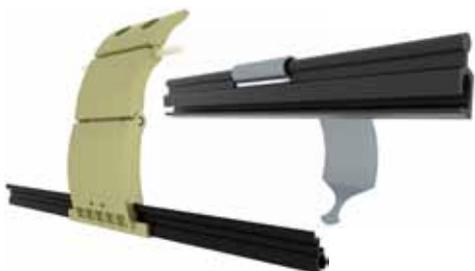
**Sicherungsfeder** – wir unterscheiden zwischen Sicherungsfeder (auch Stahlbandaufhänger genannt) und Hochschiebesicherung. Sicherungsfedern dienen zur Verbindung des Rollladenpanzers mit der Rollladenwelle. Die Sicherungsfedern werden im Regelfall in der Rollladenwelle eingehängt.
