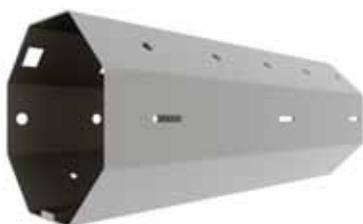
**Stahlwelle** – ist im Regelfall ein 8-Kant-Rohr aus verzinktem Stahl, mit einer Wandstärke (Materialdicke) von 0,6 bis 0,8 mm, mit einer innen- oder außenliegenden Schweißnaht. Erhältlich sind diese Wellen hauptsächlich mit Durchmessern von  $\varnothing$  40 mm und  $\varnothing$  60 mm. An der Welle wird der Rollladenbehang befestigt.
