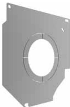
**Abweisbleche** – flache Bleche mit einer Dicke von ca. 1 mm. Sie haben die Form der Seitendeckel (auch Blendkappen genannt) des Rollladenkastens und werden als Abweisbleche zum Schutz gegen das seitliche Verschieben des Rollladenpanzers eingesetzt.
