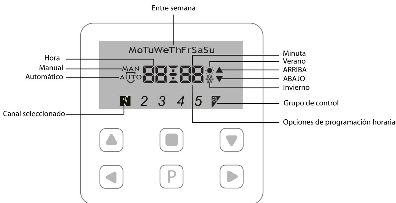
El paso del horario de verano al de invierno se realiza automáticamente según los días fijados. La fecha actual debe ajustarse correctamente durante la programación inicial.
