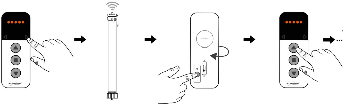
Sélectionner le canal souhaité en appuyant sur la touche K1 (ou K2) (la LED du canal sélectionné s'allume).
