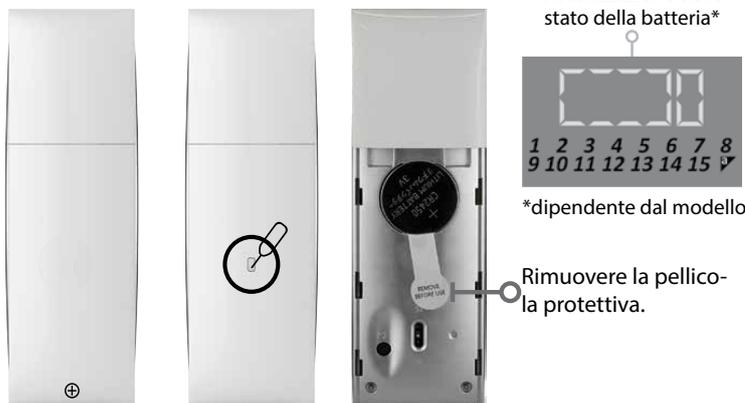
La batteria viene fornita sciolta (a seconda del modello di trasmettitore) o già installata e protetta contro lo scaricamento con una pellicola protettiva. Per sostituire/inserire la batteria, aprire il coperchio posteriore premendo leggermente\*, rimuovere la pellicola protettiva e inserire la batteria nel vano batteria con il lato + (plus) rivolto verso l'alto, come mostrato. Quindi richiudere il coperchio posteriore.
